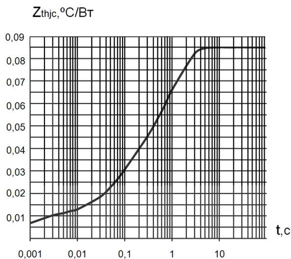
Рис. 2. Переходное тепловое сопротивление переход-корпус ( постоянный ток )
