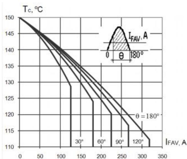
Рис. 5. Максимально допустимая температура корпуса (однополупериодный синусоидальный импульс)
